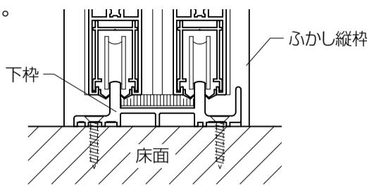
※ふかし枠（カーテンレール仕様）の場合、ふかし枠補強材（上）の固定は、別途同梱されています取付け説明書をご参照ください。
