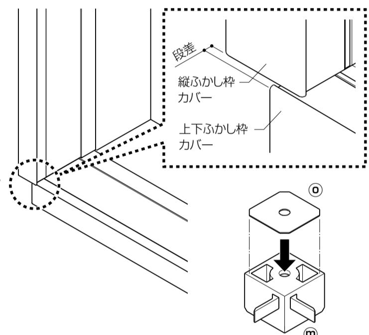
②右図のようにコーナーピースの位置決めリブをふかし枠補強材の中に入れて位置を合わせた後、ねじで固定します。
